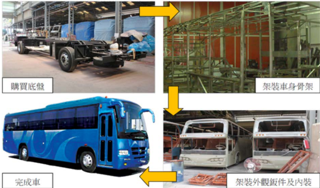
圖2：大客車的生產模式-底盤組裝車體
