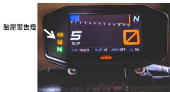
圖8：胎壓偵測輔助系統示意圖
