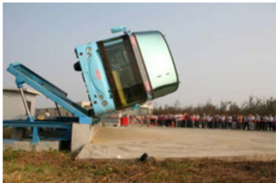
圖4：整車翻覆試驗與電腦輔助工程分析
