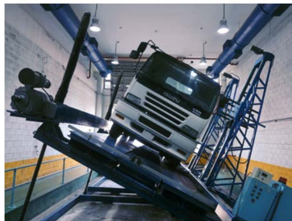
圖3：車輛傾斜穩定度測試
