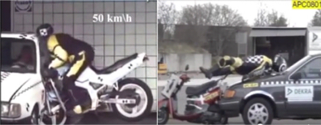
機車撞擊測試：模擬市區平均時速 50km/h，側撞、遭追撞，都將對騎士頭頸部造成嚴重傷害。(圖片: Polish Police, DEKRA)
