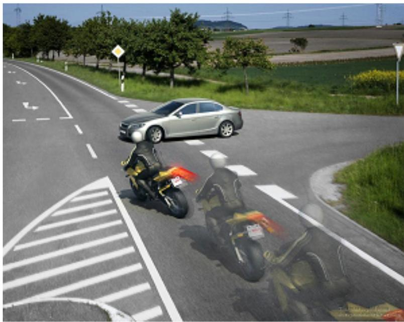
搭載 ABS 之機車，緊急情況可縮減煞車距離，
